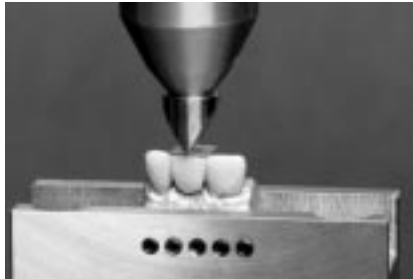
Figura 18: Misurazione del carico statico a frattura
