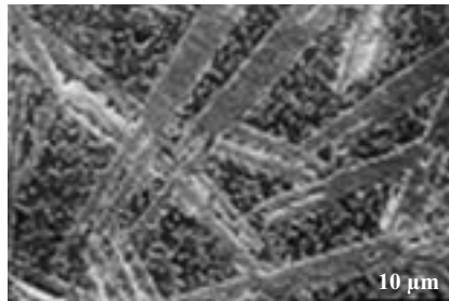
Figura 5: Ceramica vetrosa (contenente vetro) ad esempio, Empress ® III
